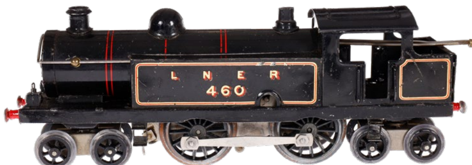
20033 Hornby 2-B-2 engl. Tenderlokomotive 460 LNER, Spur 0, CL, Uhrwerk intakt, Griffe am Umschalter fehlen, Gebrauchs- und Alterungsspuren, Z 3 100,- €
