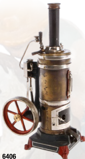
6406 Bing stehende Dampfmaschine 10/13/1, KD 6,5, mit Armaturen und Brenner, fest- stehender Zylinder, auf Guss-Sockel, tw rest. und ergänzt, H 29,5, Z 3 240,- €
