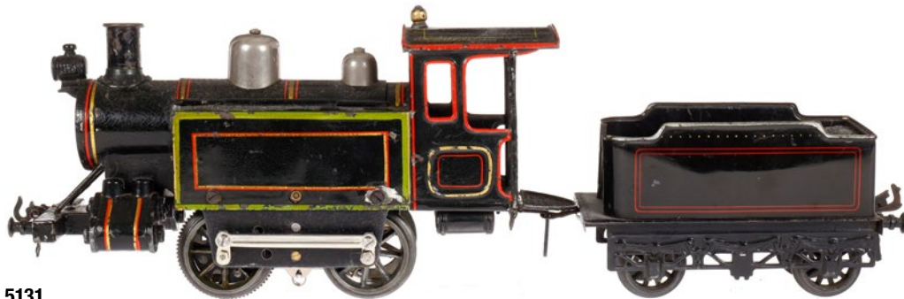
5131 Bing B-Dampflok, mit 2A-Tender, Spur 1, uralt, elektr., HL, mit Motorklappe am Kessel, Motor umgebaut, Alterungs- und Gebrauchsspuren, Z 3
